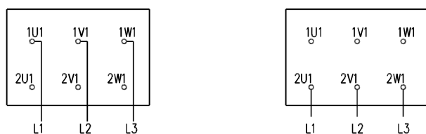
Podłączenie przewodów w skrzynce zaciskowej
