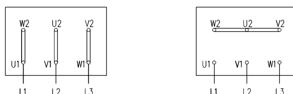
Podłączenie przewodów w skrzynce zaciskowej
