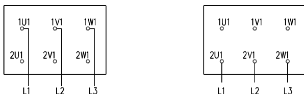
schemat połączeń uzwojenia trójfazowego dla silników dwubiegowych z dwoma oddzielnymi uzwojeniami o stosunku prędkości 1:1,5 (1000/1500 obr/min)
